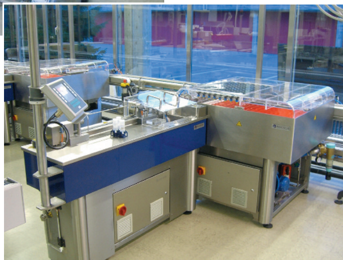
Analysestation (blau im Bild) und vorangestelltes Wärmewasserbad
