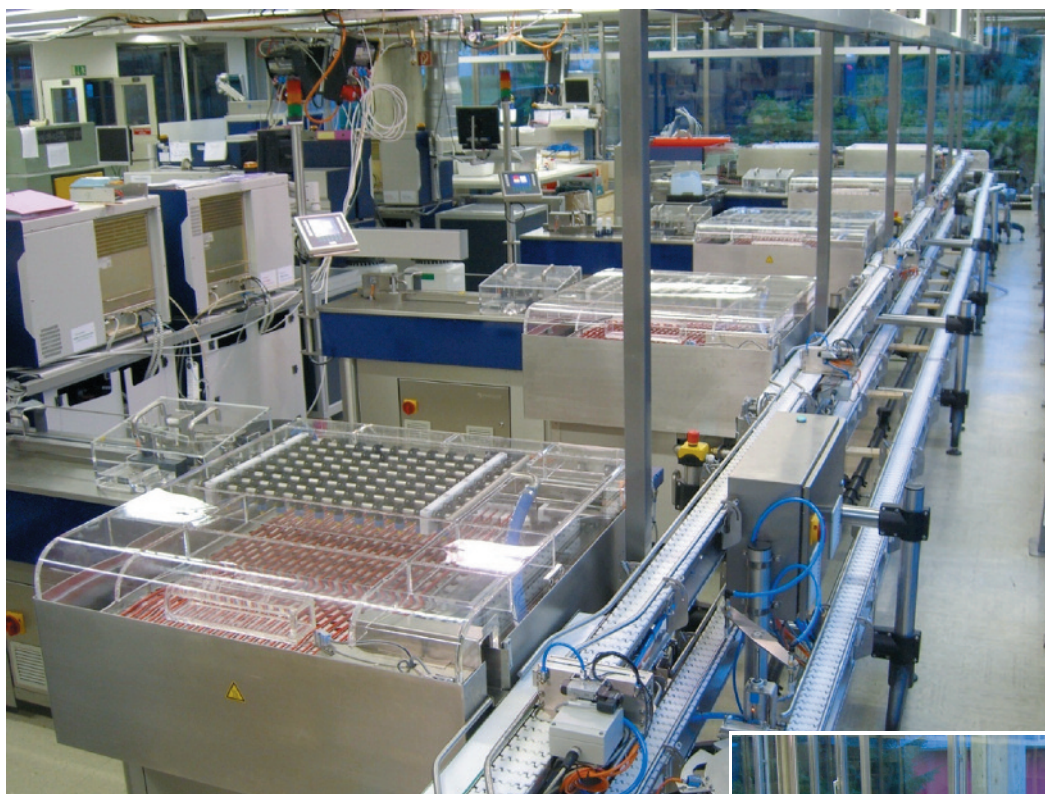
Zuführung der Flaschen auf Transportbändern zu den jeweiligen Analysegeräten in Abhängigkeit von der Information auf dem TAG (Fotos: Raudzus GmbH)
